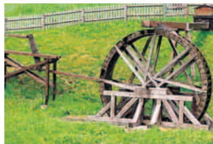
Mithilfe der Wasserräder wurden im Bergbau die Gruben trocken gehalten
